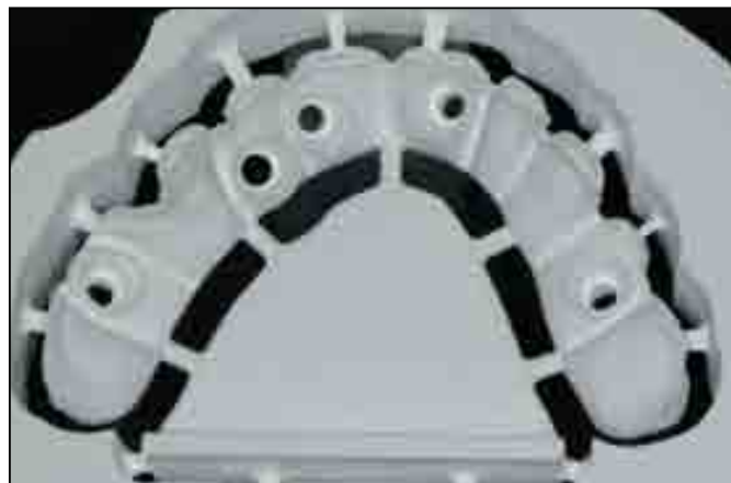
Figg. 58 e 59 Realizzazione del dispositivo in Zirconia presinterizzato così come si presenta dopo la fresatura meccanica
