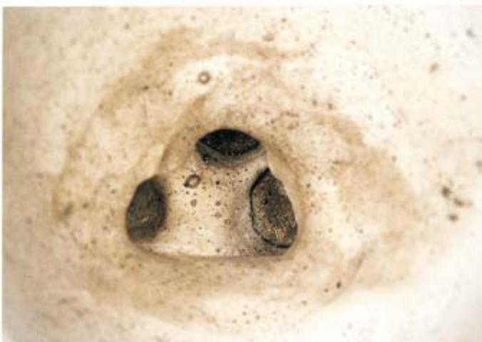
Fig. 39 Particolare della cavità conica nel cilindro dopo la fusione. Colorazione uniforme e assenza di matorozza sono indice di una corretta quantità e qualità di metallo nobile
