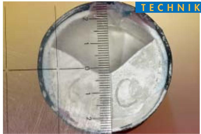
Abb. 39 Die exakt gesteuerte Expansion der Einbettmasse ist für das Gelingen eines Gusses entscheidend
