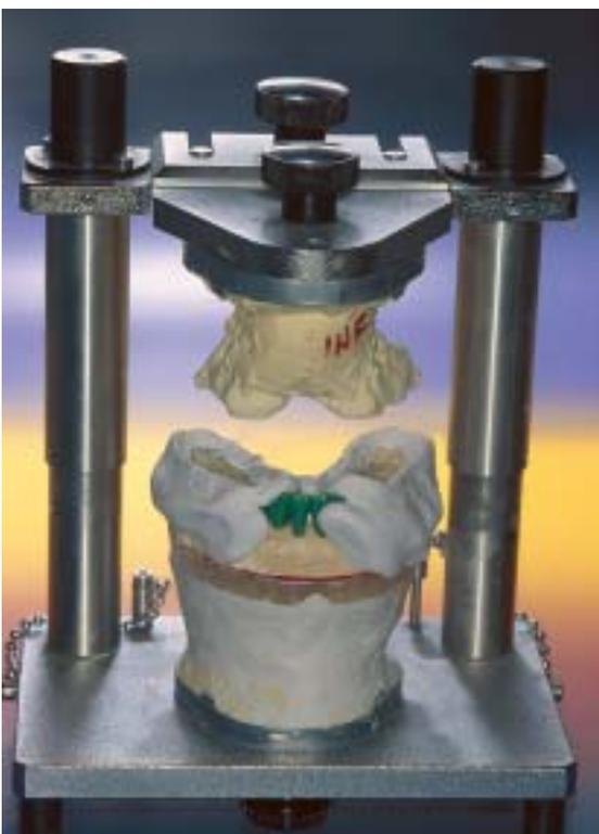
Abb. 30 Die individuelle Modellation wird mit dem Korrelator eingefroren. Diese Technik erfordert eine Serie von Arbeitsschritten, die es ermöglichen, die Daten des individuellen Wax-ups zu übertragen; damit kann das definitive Metallgerüst und die Verblendung 1:1 zur Wachsmodellation umgesetzt werden.
