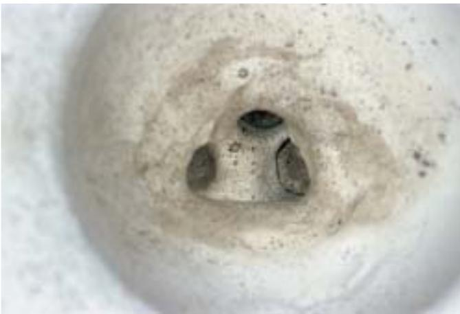
Abb. 40 Detailaufnahme des Gußzylinders nach dem Gießen. Die Färbung der Muffel ist gleichmäßig und der Metallkegel fehlt: Das heißt Quantität und Qualität des Edelmetalls waren gut bemessen.
