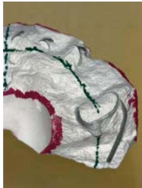
Abb. 41 Beim Ausbetten sieht man die präzise Zentrierung des Metalls und des Wärmeableiters. Beachtet man diese Details und lässt den Guss langsam abkühlen, erhält man mit Sicherheit ein gutes Ergebnis.
